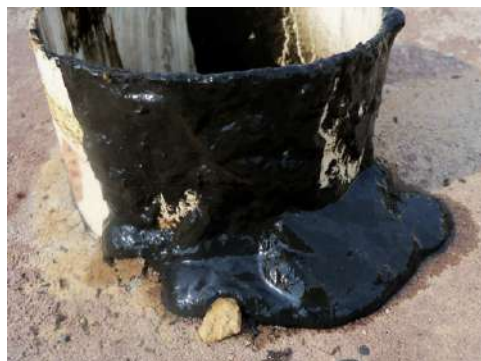
FIGURA 5. Lodo estabilizado removido do tanque séptico. Campinas-SP (Foto: Luana Cruz).
