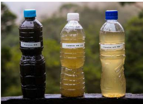
FIGURA 4. Amostras do esgoto bruto, depois de passar pelo tanque séptico e após o vermifiltro. Projeto Protegendo as Águas-SFX (Foto: Danilo Ferrara).
