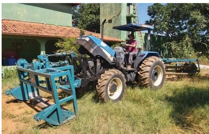
Foto 2. Equipamentos utilizados na formação de SAF: enleiradeira e encefadeira
