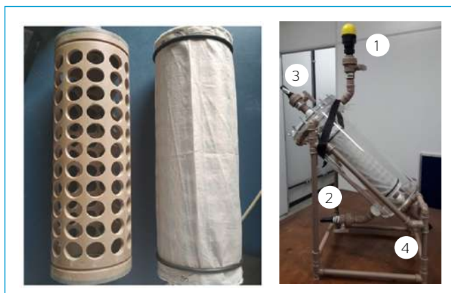
Figura 9 - Imagens do módulo de membrana dinâmica antes de iniciar a operação: (1) válvula de purga de gás; (2) descarte de lodo; (3) entrada de efluente; (4) saída do permeado.
