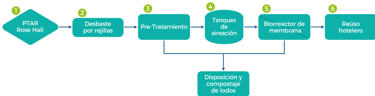
Figura 26: Proceso operativo de la PTAR Rose Hall Utilities Limited
