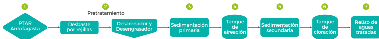
Figura 3: Proceso de tratamiento de la PTAR Antofagasta
