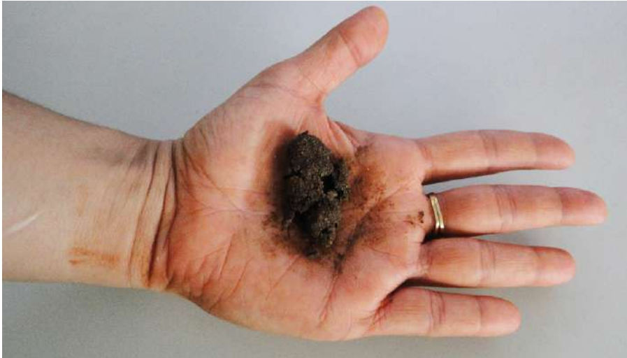
FIGURA 29. Aspecto do solo de textura média (permeável). Detalhe da cobrinha quebradiça, que indica moderada pegajosidade e plasticidade (Foto: Isabel Figueiredo).
