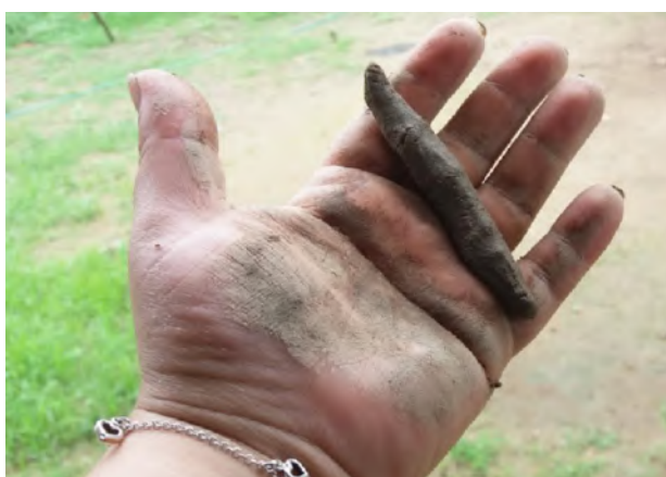
FIGURA 32B. Detalhe da "cobrinha" bem formada (Foto: Rachel Germiniani Resende).
