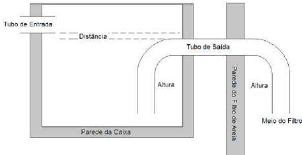
FIGURA 4. Esquema de caixa sifonada que gera aplicações do esgoto em pulsos no filtro de areia.
