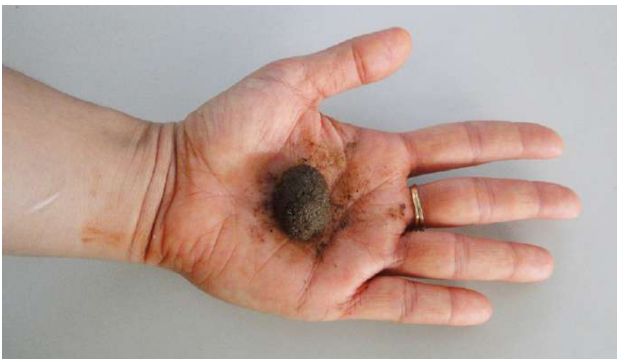
FIGURA 26. Bolinha feita com a massa de solo úmido (Foto: Isabel Figueiredo).
