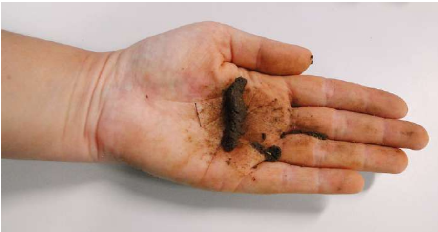
FIGURA 30. Aspecto do solo siltoso (moderadamente permeável). Aspecto fosco, liso e quebradiço (Foto: Isabel Figueiredo).
