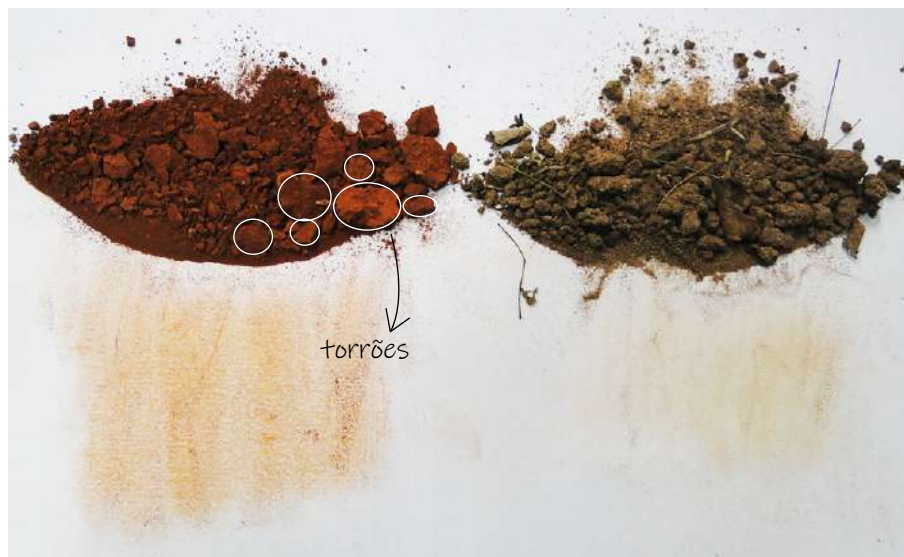
Figura 24. Torrões ou agregados em diferentes amostras de solo. Estes devem ser quebrados/amassados antes de realizar os testes (Foto: Isabel Figueiredo).
