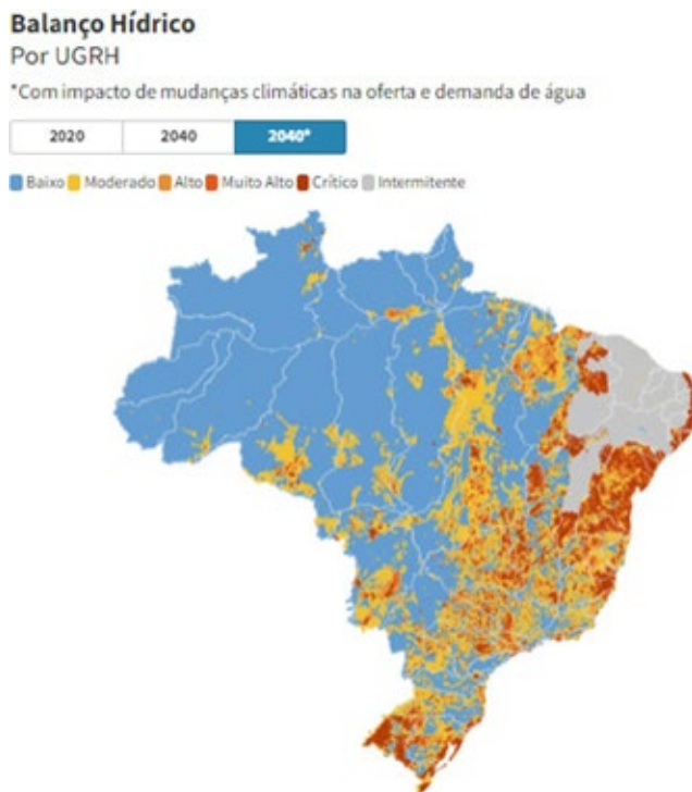
Figura 1 - O balanço hídrico por Unidade Gerenciadora de Recursos Hídricos (UGRH) com o impacto da mudança do clima, com uma projeção para 2040.
